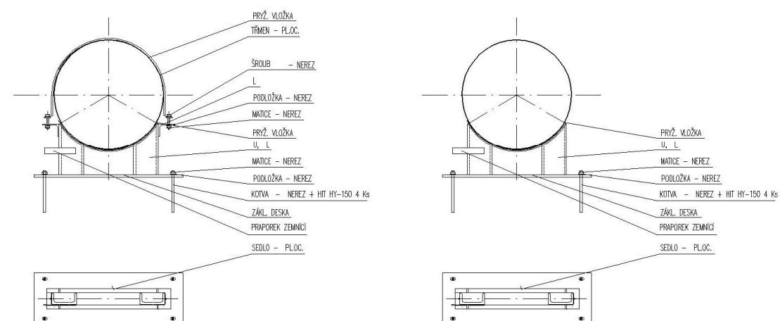
Vodovodní potrubí je kotveno na definitivní podlahu hotového kolektoru, pro kotvení je nutno použít certifikované lepicí kotvy v nerezovém provedení. Veškeré ocelové prvky je nutno zabezpečit statickým výpočtem a návrhem kotvení oblouků nebo lomů trasy vodovodu a
